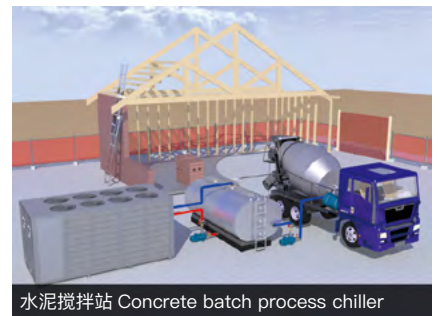
水泥搅拌站 Concrete batch process chiller
